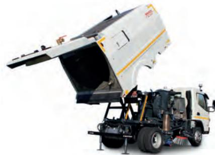
Mit der speziellen Hochentleerung ist es möglich, den **Schmutzbehälter bis auf 1,50 m Höhe anzuheben** und in einem aufgestellten Container zu entleeren.
